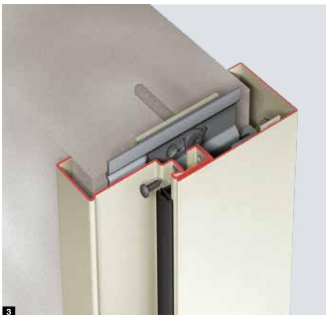
**AVEC FIXATION MASQUEE.** L'huisserie enveloppante en 2 parties **3** est particulièrement adaptée à une pose ultérieure. Dans un premier temps, seul le profilé d'huisserie d'angle est monté. Le panneau de porte peut être ajusté de manière optimale par rapport au joint directement après cette étape. L'huisserie complémentaire est ensuite montée et les deux profilés d'huisserie sont vissés dans la rainure d'étanchéité et ainsi masqués.
