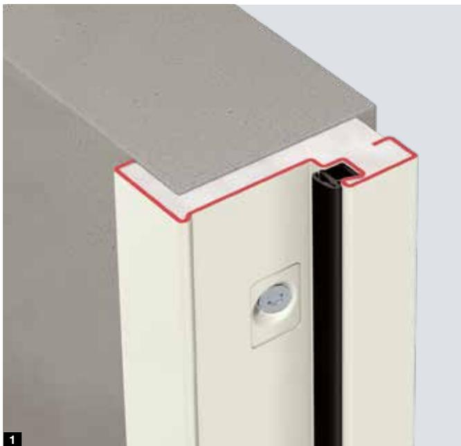
**HUISSERIES STANDARDS.** Nos nouvelles huisseries d'angle **1** permettent un montage plus rapide, plus facile et plus flexible des portes tertiaires OD. Dans l'exécution standard, une fixation diagonale et quelques raccords vissés suffisent pour un montage rapide de l'huisserie. L'huisserie peut être facilement adaptée à différentes situations de montage à l'aide de kits de montage en option.
