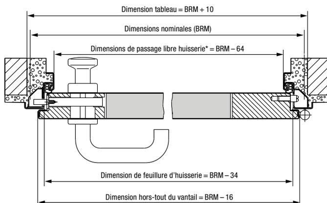
\*) Sans prise en compte de poignées ni de béquilles, la largeur de passage libre pour un angle d'ouverture de 90° diminue de 2 mm.
