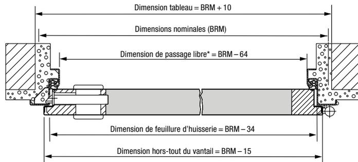
\*) Sans prise en compte de béquilles, la largeur de passage libre pour un angle d'ouverture de 90° diminue de 2 mm, pour une porte à 2 vantaux de 4 mm.
