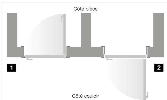
La porte à ouverture inversée (DIN gauche) s'ouvre sur la pièce **1** et la porte affleurante à ouverture normale (DIN droite) s'ouvre sur le couloir **2**
